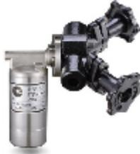
**В цельносварном корпусе из нержавеющей стали** конденсатоотводчики имеют малый вес, в целях обеспечения безопасности и минимизации риска утечек могут оснащаться интегрированными присоединительными узлами, включающими отсечные вентили и продувочный клапан в моноблочном исполнении. При наличии остатков конденсата в корпусе сохраняют живучесть при низких температурах.
